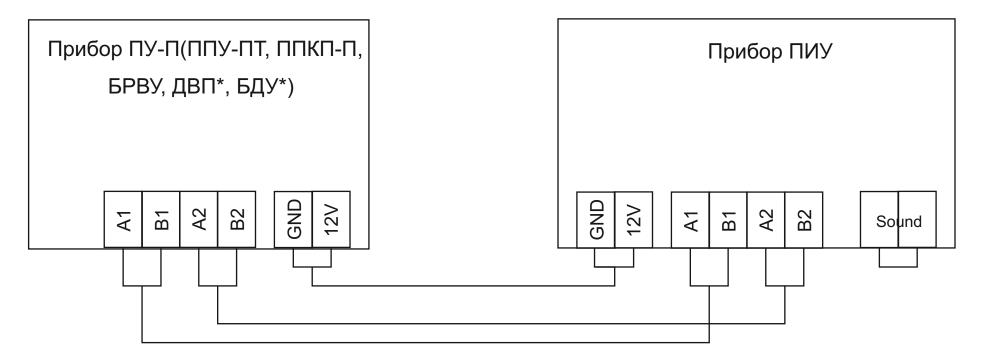
Прибор ПУИ подключается к межприборной шине системы «Омега» А1,В1, А2, В2, занимает адрес в адресном пространстве ППКП-П. Электропитание прибора может подаваться с внешних выходов любого из приборов, за исключением ДВП\* и БДУ\* или от внешнего источника питания.
